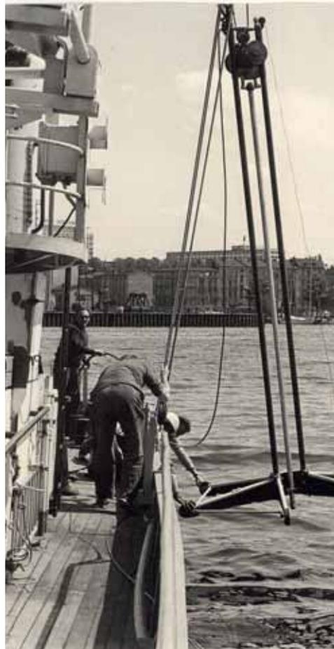
Abb. 12: Erprobung des Vibrationsstechrohrs des Instituts für Meereskunde im Rostocker Stadthafen, ohne Absetzgestell durch Kopplung auch für Kerne bis zu 9 m einsetzbar (Foto: K. Schmedemann).
