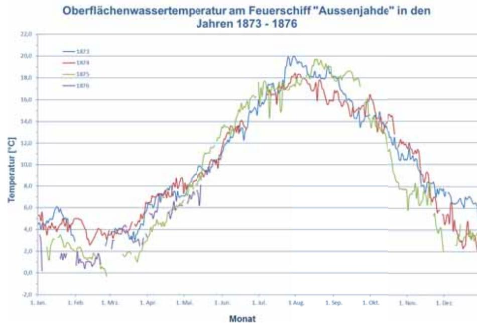
Abb. 12: Erste graphische Darstellung der Wassertemperaturen auf der Feuerschiffposition Aussenjahde (Außenjade) 1873 – 1876 (Autor).
