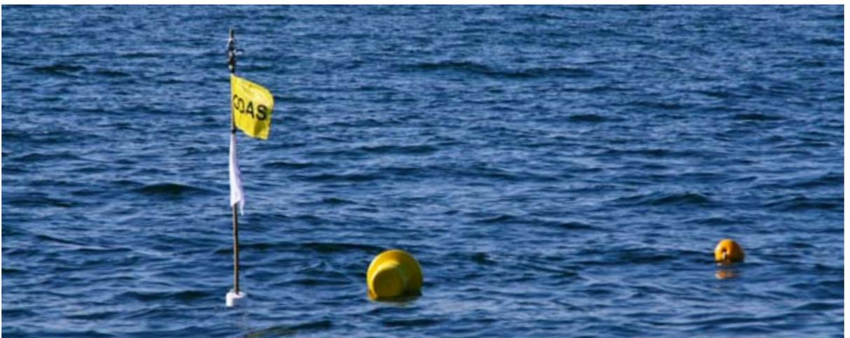
Abb. 9: Oberflächenmarkierung einer Messstation. Mit einer ODAS-Flagge werden schwimmende Einrichtungen, mit denen ozeanographische Daten gemessen werden, gekennzeichnet.
