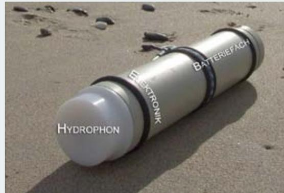
Abb. 1: Gerät zur Registrierung von Echoortungslauten (CPOD). Geräusche werden über das Unterwassermikrophon (Hydrophon) aufgenommen, die Elektronik verarbeitet die Informationen und speichert Details, wie z. B. die Lautstärke des Signales, die Frequenz und die Temperatur ab. Mit Strom wird das Instrument durch bis zu zehn Monozellen versorgt, die auch im kalten Wasser über lange Zeit stabil arbeiten.
