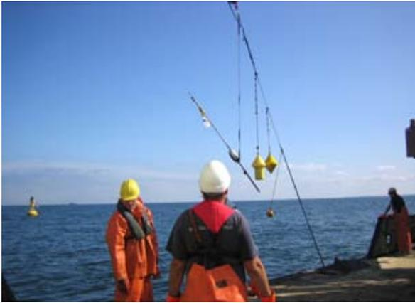
Abb. 25: Das Mehrzweckschiff „Scharhörn“ des Wasser- und Schifffahrtsamtes Lübeck birgt das Verankerungs-System eines Schweinswaldetektors.
