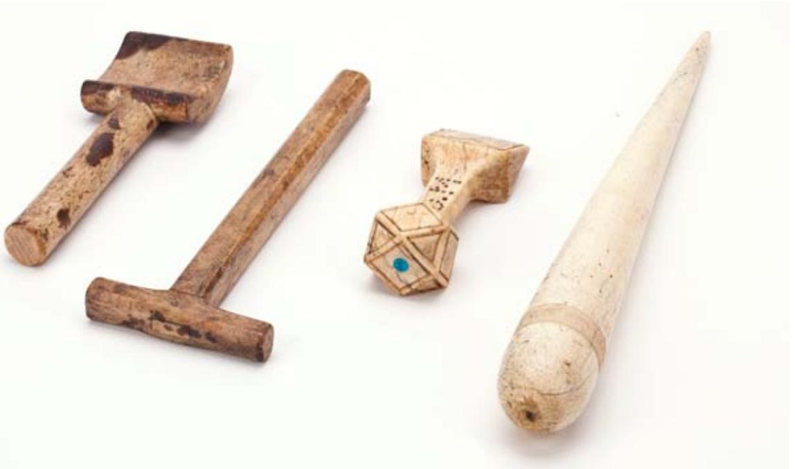
Abb. 6: Werkzeuge an Bord: Fitte für Spleißarbeiten, ein Hammer aus Knochen, ein Seamer aus Zahn mit polygonem Griffknauf und eine Kledkeule für das Bekleiden von Tauwerk mit dünnerem Garn (v.l.n.r.).
