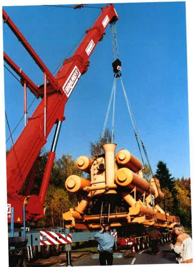
Abb. 2: Verladung des 86 Tonnen schweren UWL im GKSS Forschungszentrum Geesthacht auf einen Tieflader.
